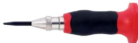
Bulino automatico per meccanici, corpo in acciaio nichelato con impugnatura di protezione bimeriale, battuta a scatto tramite dispositivo caricato a molla con profondità di incisione regolabile mediante regolazione della vite zigrinata, punta in acciaio temperato riaffilabile e sostituibile.
